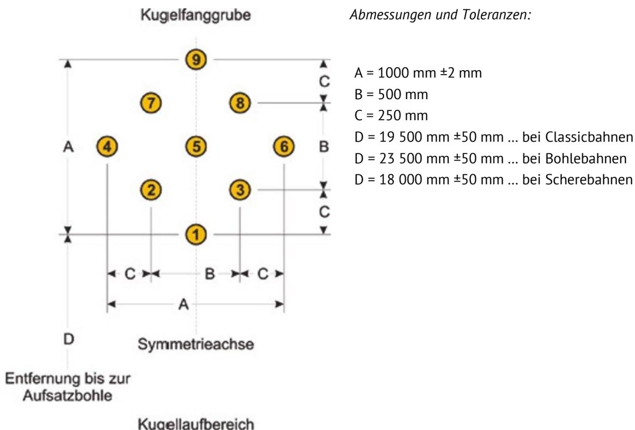
Die vorgeschriebene Form der Standplatte und deren Abmessungen sind in der *Abbildung 5* gezeigt. Zugelassen sind Kegelstandplatten aus Stahl oder Kunststoff.
