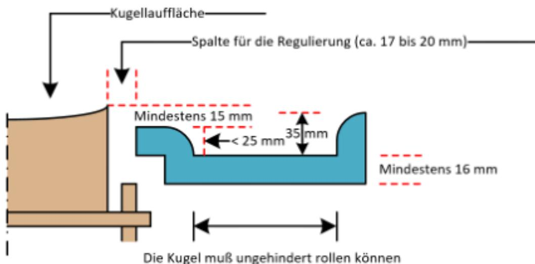
Wenn der Spalt für die Regulierung  $< 17$  mm oder mit Leisten überdeckt ist, müssen die Fehlwurfrinnen ggfs. für die Korrektur ausgebaut werden.
